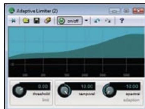
Schneller Limiter mit frequenzunabhängigem Peak-Verhalten
